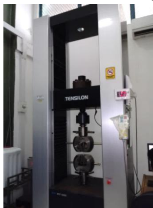
Gambar 2 Mesin uji tarik Tensilon RTF-2425 S (Sumber: dokumen pribadi di Workshop BLK Makassar)
