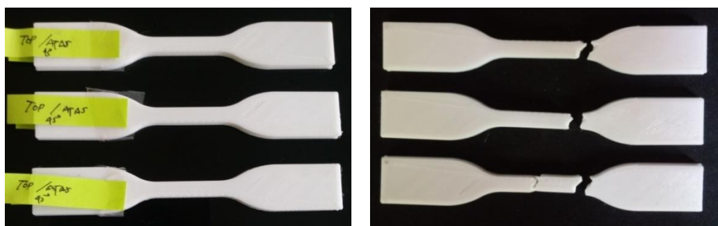
Gambar 6 Spesimen PLA+ infill angle 45° sebelum dan sesudah uji tarik
